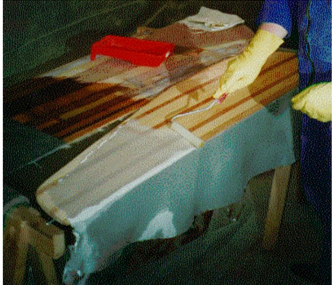
darauf, die Lagen nicht zu verschieben, versuchen sie aber, möglichst viel Harz wieder aus dem Glas herauszustreichen und trotzdem alle Luftblasen zu entfernen. Die Mattenstruktur sollte an der Oberfläche ganz leicht sichtbar werden.
