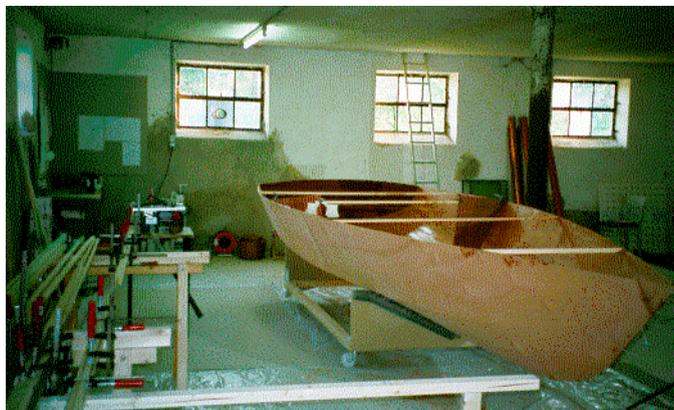
erhält durch eine Epoxibeschichtung und/oder Konservierung mit Zweikomponenten-PU-Lacken Langlebigkeit und braucht im Frühjahr nur gewachst und poliert zu werden. Jedoch sollten kleine Schäden bald
