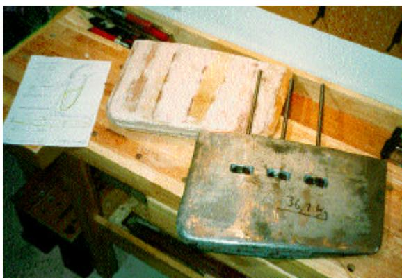
In seinem Drehpunkt ist das Schwert später so hoch belastet, daß der Kern hier noch weiter verstärkt werden muß. Dazu haben wir eine kräftige Edelstahlbuchse drehen lassen und eingeklebt (Bronze wäre auch geeignet, kann aber mit einem Schwertbolzen aus Edelstahl zu Spannungskorrosion führen).
