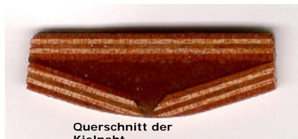
Querschnitt der Kielnaht
