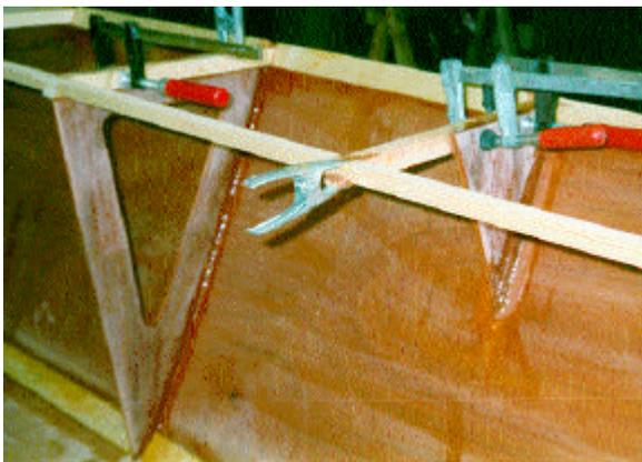
Da die Rahmen der Decksunterkonstruktion normalerweise vor den Platten, d.h. freischwebend eingebaut werden, läßt sich die Länge der einzelnen Leisten nicht immer gleich exakt bestimmen. Lassen sie dann die Leistenenden wenige Zentimeter überstehen und passen sie sie nach dem Aushärten mit Feinsäge und Schleifklotz an.
