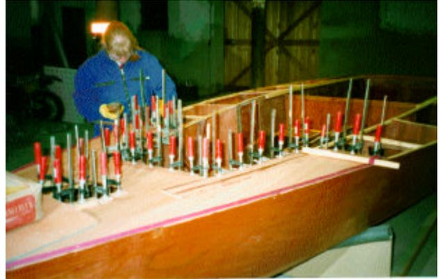
Streichen sie nach dem Kleben austretenden Leim möglichst gleich gründlich ab. Das spätere Beis Schleifen ist gerade an diesen Stellen eine sehr undankbare Arbeit und man schleift leicht durch die Deckfurniere.
