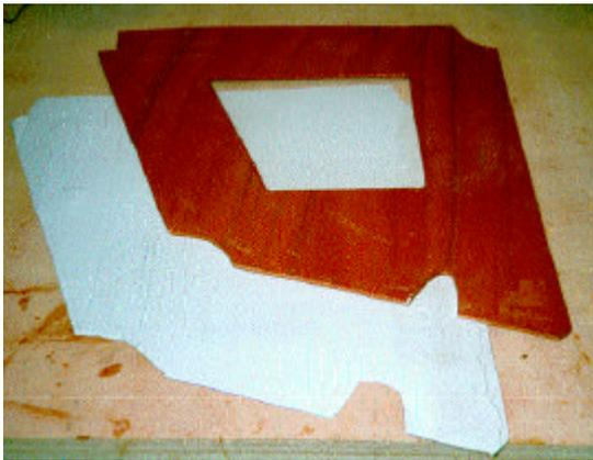
Legen sie danach die Pappe auf ein Stück Sperrholz und fahren mit dem Bleistift die Kontur ab. Dabei wird die übertragene Form automatisch rundum einen knappen Millimeter größer. Diese Zugabe erlaubt später ein Glätten der Schnittkanten und eine noch genauere Anpassung des Schotts mit dem Surformhobel oder der Raspel.
