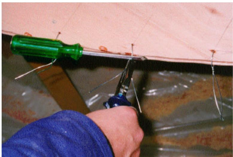
einfachem 1,2mm Stahldraht gearbeitet. Hiervon haben wir ca. 100 Stücke zu 20cm vorgeschritten. Außerdem legen sie sich noch eine Kombizange und einen Saitenschneider, einen mittelgroßen Schraubenzieher und die Bohrmaschine mit 3mm Bohrer zurecht.
