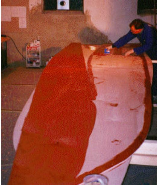
Weiter geht´s mit dem Bohren. Markieren sie ca. 1,5cm vom Rand aller zukünftigen Nähte eine Linie. Entlang der Kiellinie bohren sie nun ca. alle 25 cm ein Loch von 3mm ø in die markierte Linie. In starken Krümmungen und an Bug und Heck dichter, ca. alle 10-15cm. Die Kimmnaht bohren sie nur entlang einer Kante. Die Gegenseite verschiebt sich stark und muß deshalb später passend gebohrt werden.
