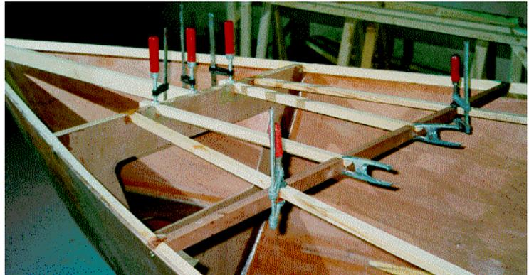
Optimal ist es, die Leisten so auszunehmen, daß sie ineinandergreifend verklebt werden können. Dabei wird immer die Leiste mit kleinerem Querschnitt in die größere eingelassen. Dies sollte so geschehen, daß hinterher unter dem Einschnitt noch Material der Leiste und obenauf das der Sperrholzplatte liegt.
